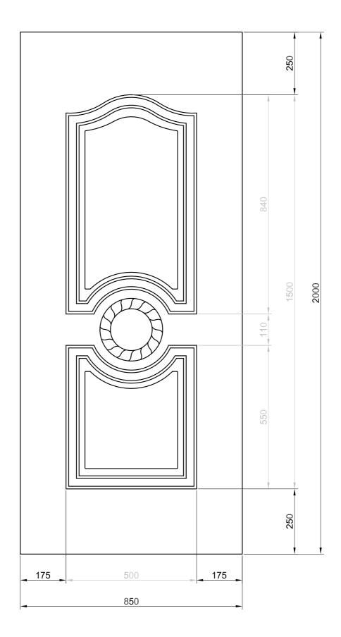
Maximálny rozmer / Maximal measures / Maximale Abmessung: 850mm x 2000mm Minimálny rozmer / Minimal measures / Minimale Abmessung: 560mm x 1560mm
